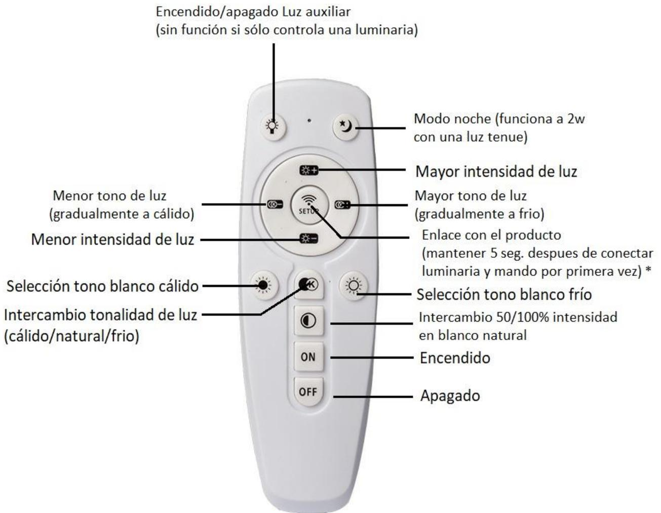
\* Para realizar el emparejamiento del mando mantenga pulsado 5 segundos el botón hasta que la luz de la luminaria parpadee. Si el emparejamiento no se realiza desconecte la luminaria de la corriente y quite las pilas al mando y vuelva a realizar el proceso hasta que se realice el emparejamiento.
